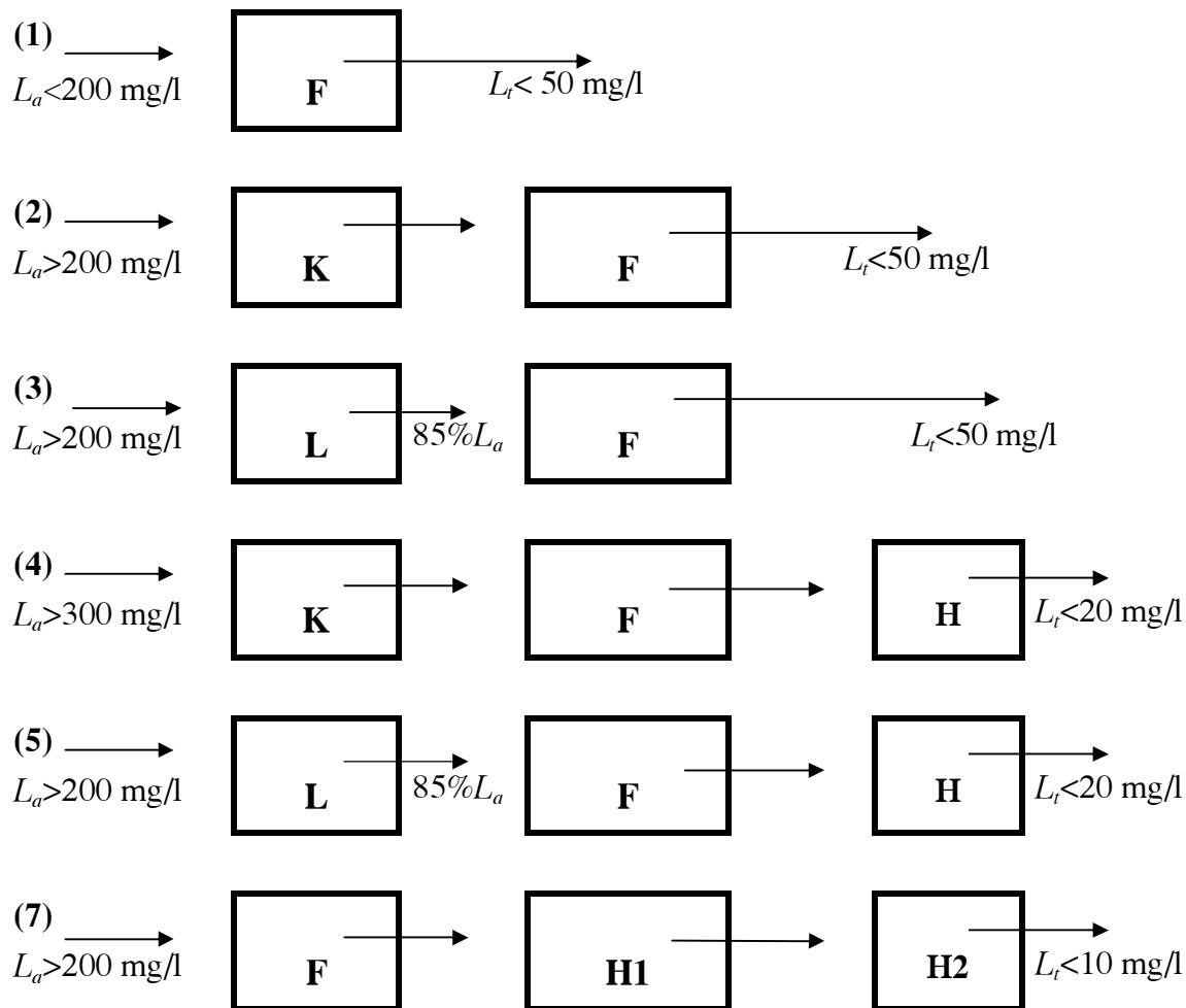
**Ghi chú:** F-hồ tùy tiện; K- hồ kỵ khí; H- hồ hiếu khí; H1- hồ hiếu khí bậc một; H2- hồ hiếu khí bậc hai; L- hồ lắng;  $L_a$ -BOD của nước thải chưa xử lý;  $L_t$ - BOD của nước thải sau xử lý trong hệ thống hồ.
